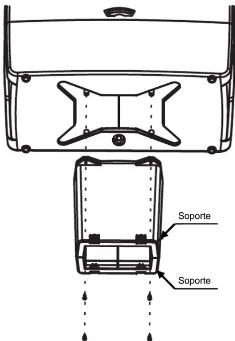
Ajuste el soporte con la base del equipo y asegúrese que los orificios para tornillo estén alineados en ambas partes. Utilice los tornillos para unir el soporte con la base del equipo.
