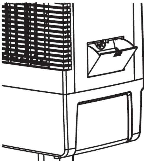
El acceso al tanque de agua se encuentra en un costado del equipo. Para acceder a este, presione la parte superior de la compuerta para abrirla. Llene el tanque de agua con una jarra o con una manguera. Recuerde no llenar de más el equipo.
