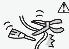
No teja, tire o presione el cable de alimentación, de lo contrario el cable de alimentación puede dañarse. Una descarga eléctrica o un incendio pueden ser probablemente causados por un cable de alimentación dañado.
