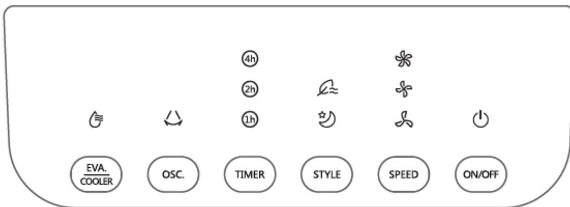
1. **ON/OFF:** Presione una vez para encender el equipo, presione una vez nuevamente para apagarlo.
