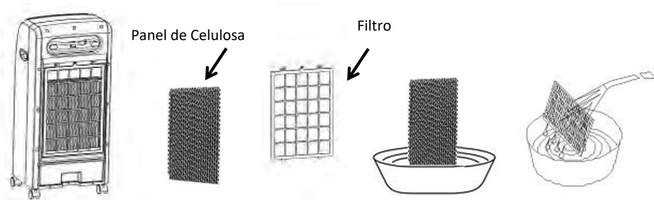
El depósito de agua deberá limpiarse cuando esté lleno de polvo o suciedad después de un largo tiempo de uso. El procedimiento de limpieza es el siguiente:
