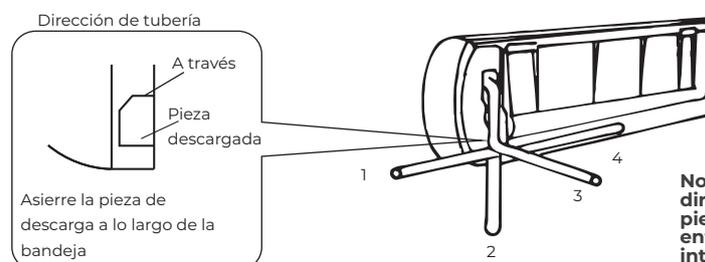
**Nota:** Al instalar la tubería en las direcciones 1, 2, o 4, asierre la pieza descargada correspondiente desde la base de la unidad interna.
