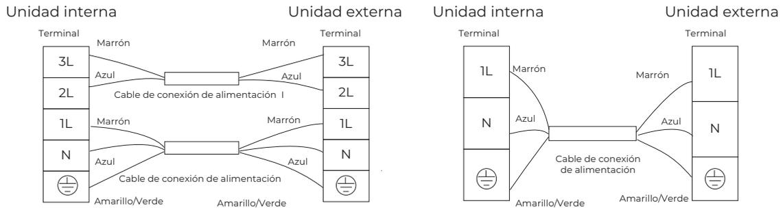
Para los modelos arriba mencionados, la fuente de alimentación está conectada desde la unidad interna. Para algunos modelos, el cable a tierra puede estar conectado a la caja eléctrica directamente.
