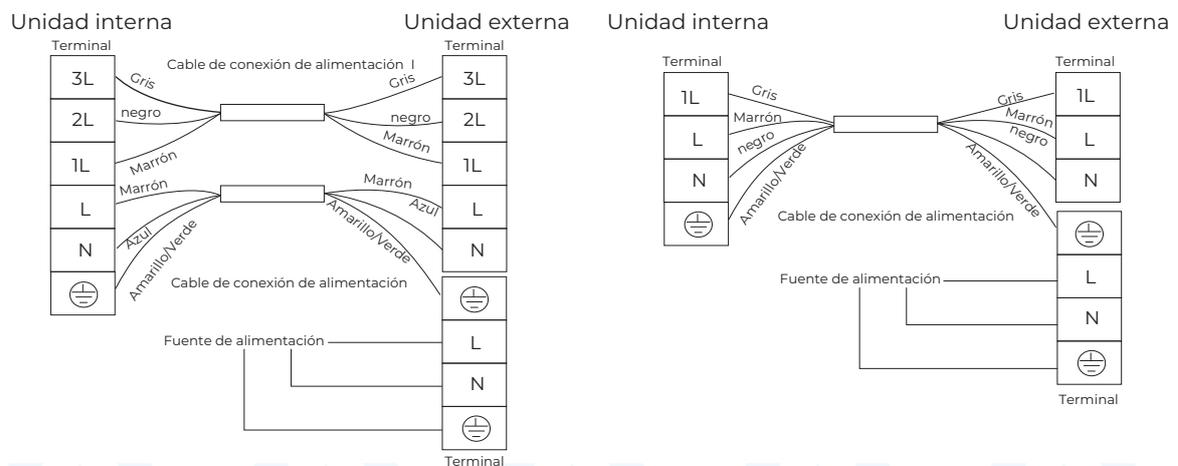
Para estos modelos, la fuente de alimentación está conectada desde la unidad externa, con un interruptor automático.
