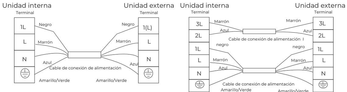
Para los modelos arriba mencionados, la fuente de alimentación está conectada desde la unidad interna. Para algunos modelos, el cable a tierra puede estar conectado a la caja eléctrica directamente.
