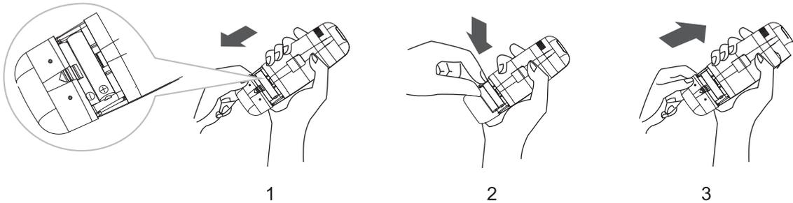
**Nota:** Utilice 2 baterías de LR03 AAA (1.5V). No utilice las baterías recargables. Reemplace las baterías con las nuevas del mismo tipo cuando la pantalla se oscurece.
