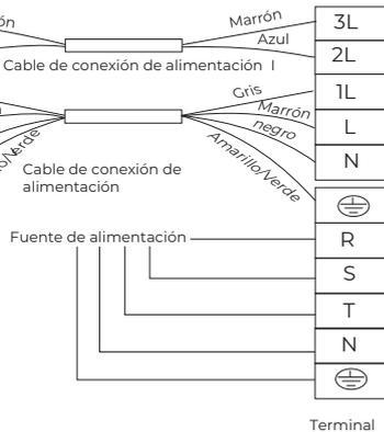
Para estos modelos, la fuente de alimentación está conectada desde la unidad externa, con un interruptor automático.
