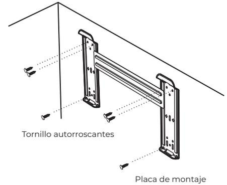
**Nota:** La forma de su placa de montaje puede ser diferente de la arriba mencionada, pero el método de instalación es similar.
