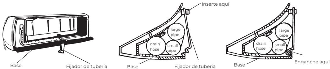
A. Inserte el fijador de tubería en la ranura.
