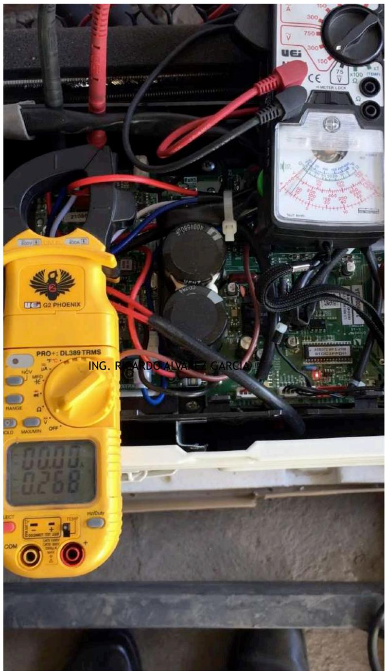
**VOLTAJE EN ALTERNA ALIMENTANDO AL COMPRESOR**
