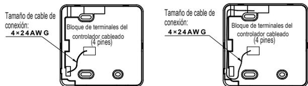
Conecte el bloque de terminales de controlador cableado con bloque de terminales interior mediante el cable de conexión. Para los detalles, consulte el diagrama de cableado interior.
